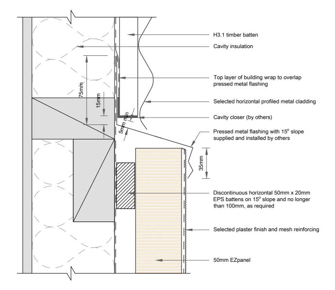
**19B** HORIZONTAL JOINT - METAL PROFILE SCALE: 1:2 EZPANEL
